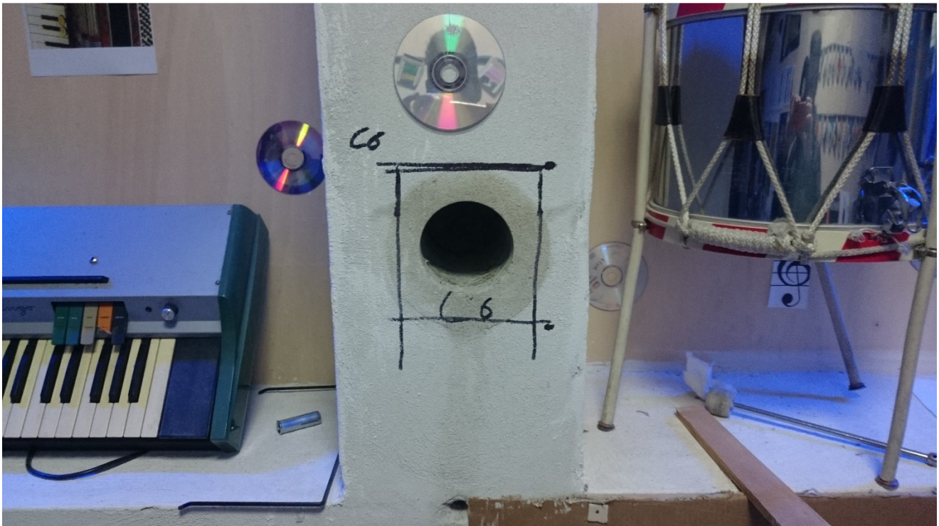
Particolare foro per prelievo carota di cls
