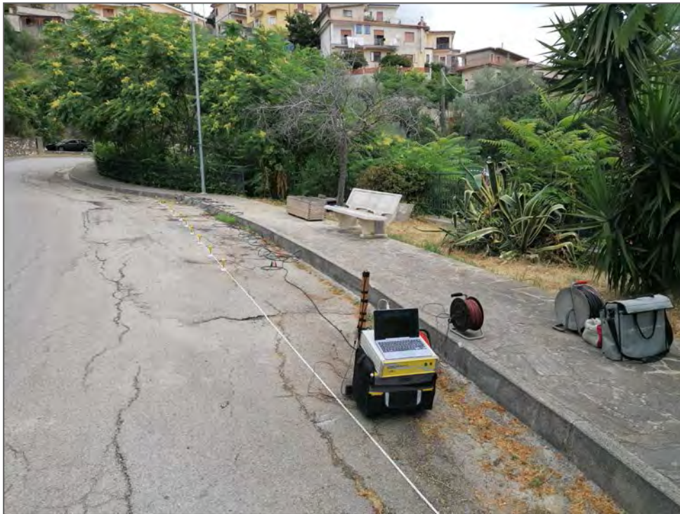
Foto 1: Stendimento di 12 geofoni a frequenza di 4.5 Hz (MASW N. 1)
